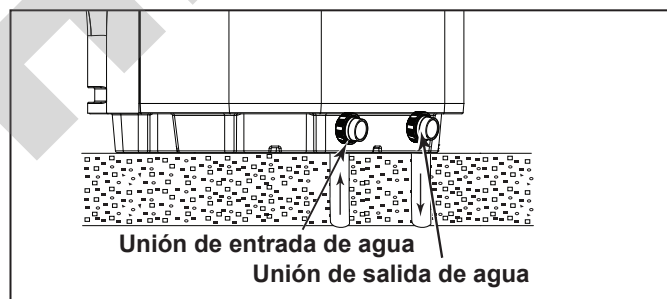
Figura 14. Preparación de la bomba de calor JRT para el invierno
